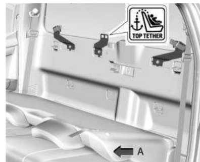
Pontos de ancoragem
